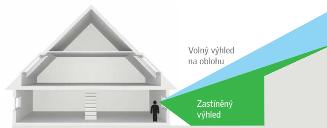
Obrázek 1.13: Složky výhledu. Situace v případě fasádního okna.
