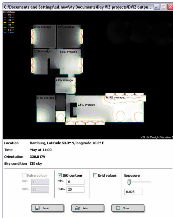
Obrázek 7.8: Snímek obrazovky z vyhodnocení koeficientu denního osvětlení v prohlížeči výsledků v aplikaci VELUX Daylight Visualizer.
