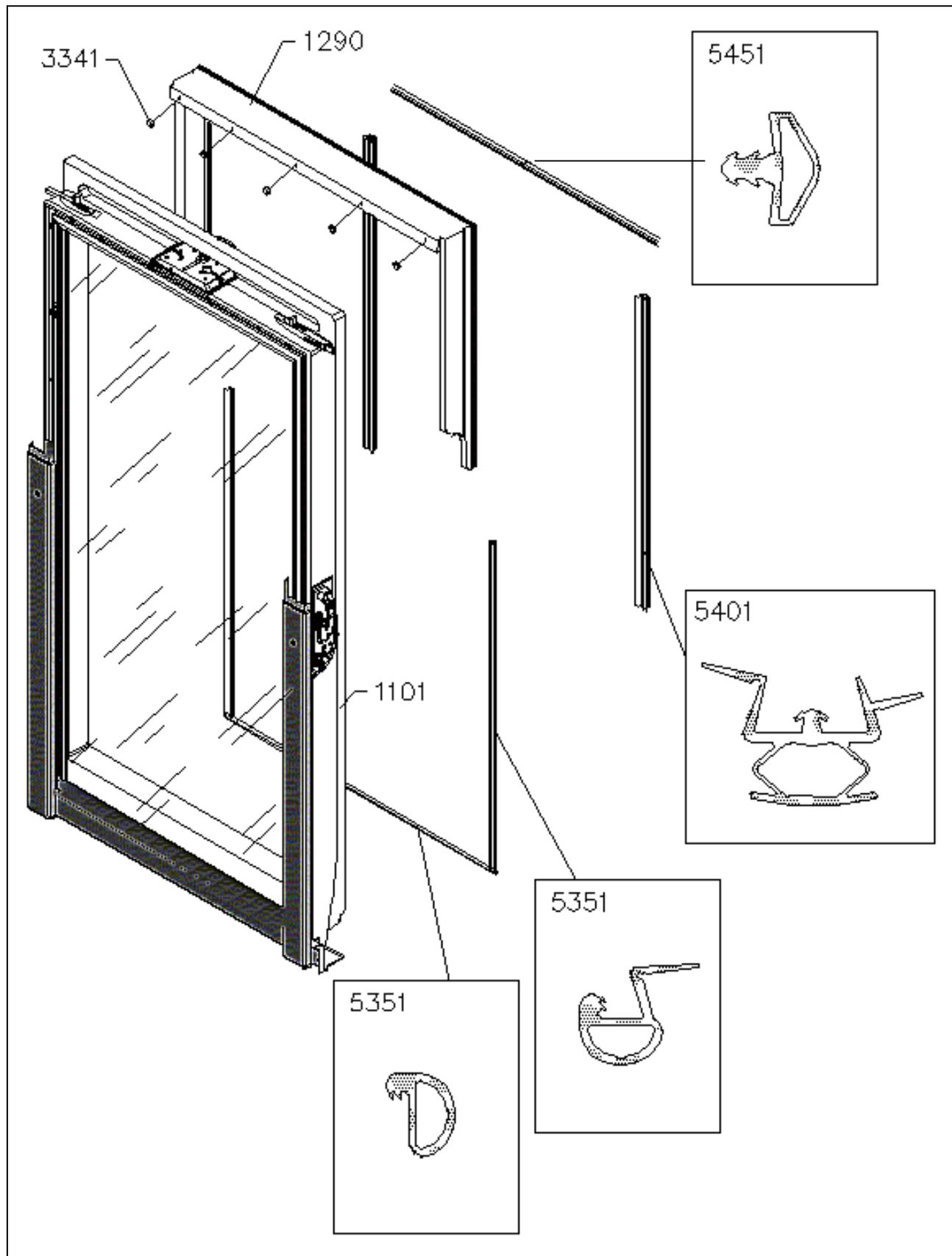
Flügel ohne Scheibe, Beschläge, Dichtungen, Kleinteile, Lüftungsklappe mit Griffleiste
