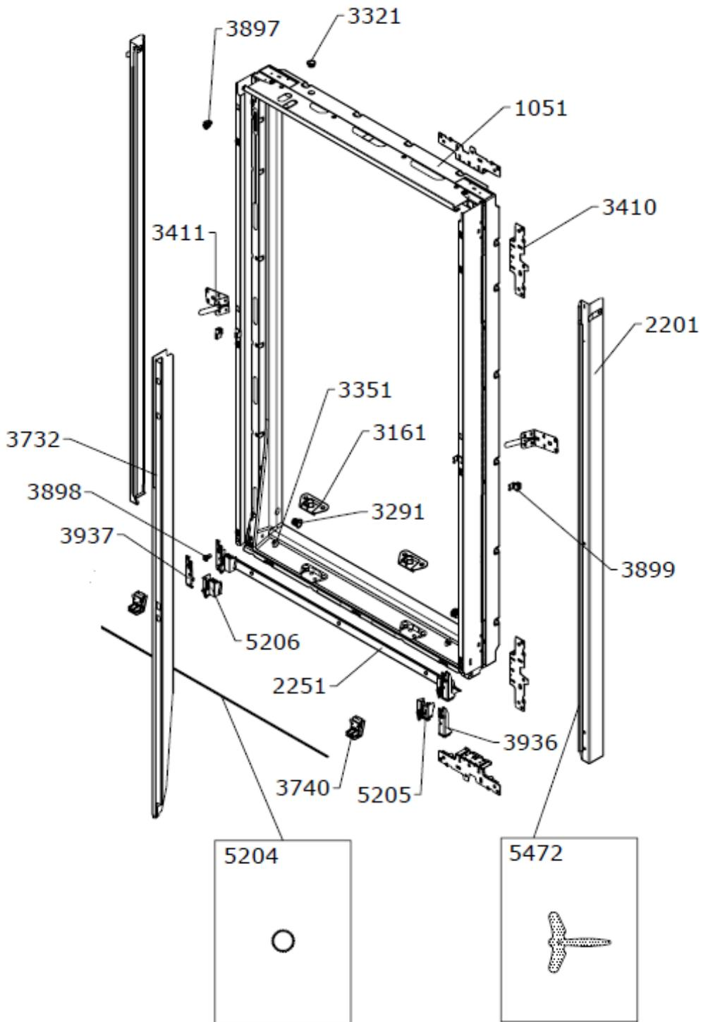
**Flügel komplett, Zwischenrahmen, Dichtungen**
