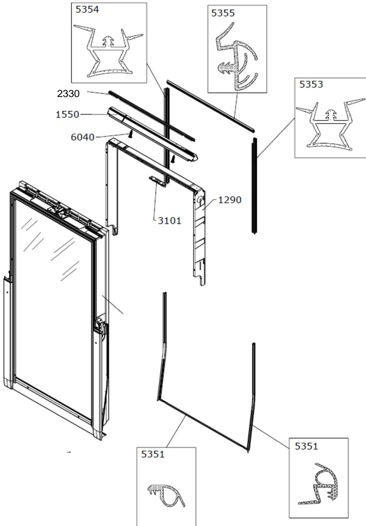
Flügel ohne Scheibe, Beschläge, Dichtungen, Kleinteile, Lüftungklappe mit Griffleiste
