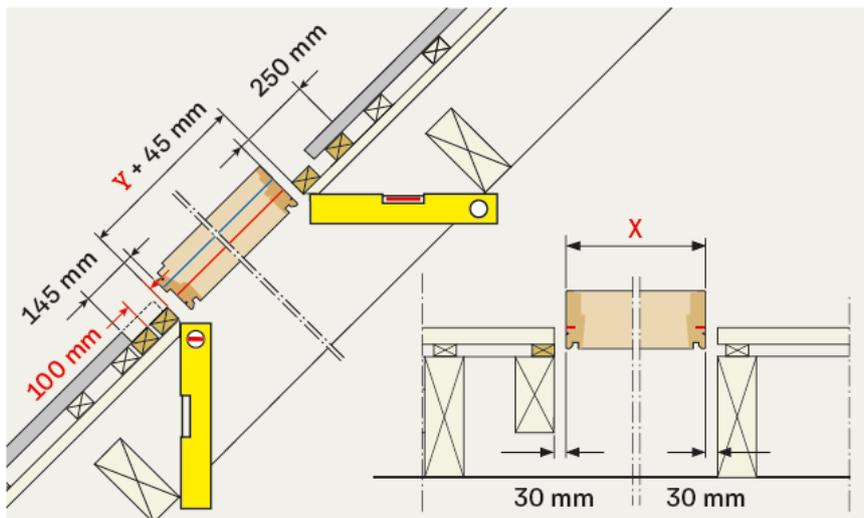
Für eine problemlose und fehlerfreie Montage ist es absolut zwingend dass VOR der Montage, also in der Planungsphase, die genaue Einbauposition des VELUX Dachfensters festgelegt wird. Hintergrund ist, dass das Dachfenster seitlich links und rechts nicht mit dem Falzen der Dacheindeckung kollidieren darf. Die genauen Abstandsmaße sind in der offiziellen Einbaubauanleitung nachzulesen,
