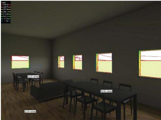
1. 室内の採光シミュレーション画像を出力できます。
