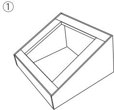
立ち上げ台を現場で作成します。ECB の場合は、組み立て図面に従って規定寸法を守り、作成してください。
