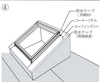
本体に同梱されている施工説明書に従って、天窓周囲にルーフィングシートを立ち上げ、各コーンナーにコーナーブチルを付けてください。
