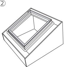
天窓本体を立ち上げ台に取り付けてください。本体の取り付け方、カバーの外し方等は本体同梱の施工説明書をご参照ください。
