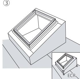
屋根材を立ち上げ台上端まで立ち上げてください。ECR の場合は、防水材を天窓本体まで立ち上げて防水処理します。
